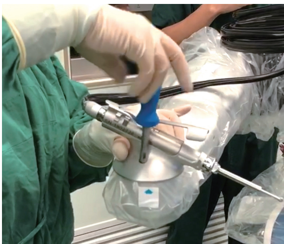
图3 固定已组装好的末梢执行器 Figure 3 Assembled end effector fixing
