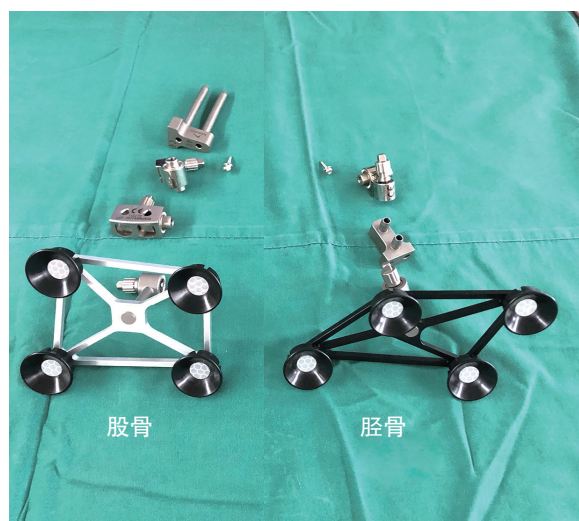
图 1 带有 VIZADISC 的股骨、胫骨阵列
