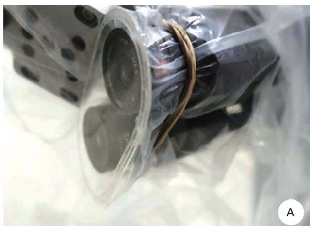
图 4A 透明硬质塑片固定在双目摄像机上并予以捆扎
