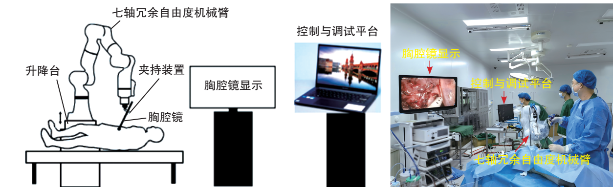
图 1 主动式扶镜机器人 Figure 1 Demonstration of robotic scope holder 注：A. 示意图；B. 实际场景图
