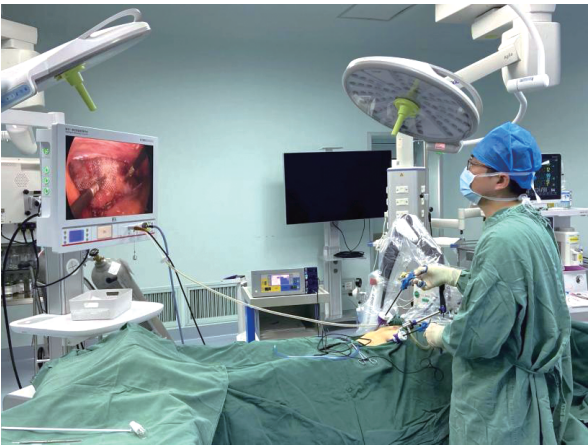
图 1 术中扶镜机器人 Figure 1 Camera holding robot
