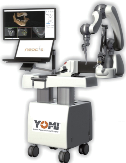
图 17 Yomi 牙科种植导航机器人系统 [53]
